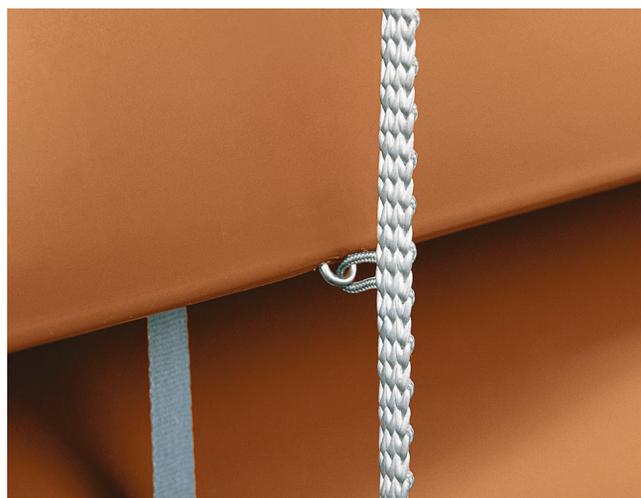
**Raccordo ottimale:** il raccordo brevettato tra lamella e cordicella, che non necessita di manutenzione, ha occhielli in acciaio inossidabile che si collegano alla guarnizione senza indebolire le lamelle.
